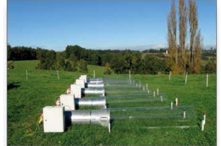
図1 - 永年牧草地に液状堆肥と尿素を散布した後のアンモニアの放出を調べるために使われる小規模の風洞技術
