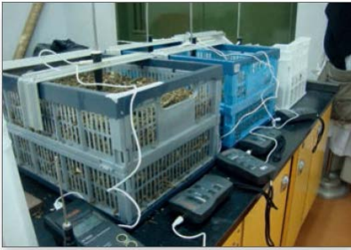
図1－試験工場にある堆肥化用に混合された廃棄物が入ったリアクター
