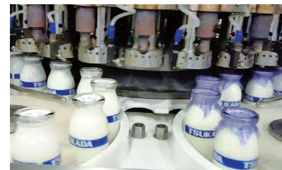
学乳の製造ライン。2010年には学乳専用瓶を導入し、品質管理の一層の強化を図っている。
