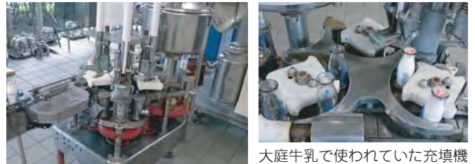
大庭牛乳で使われていた充填機
