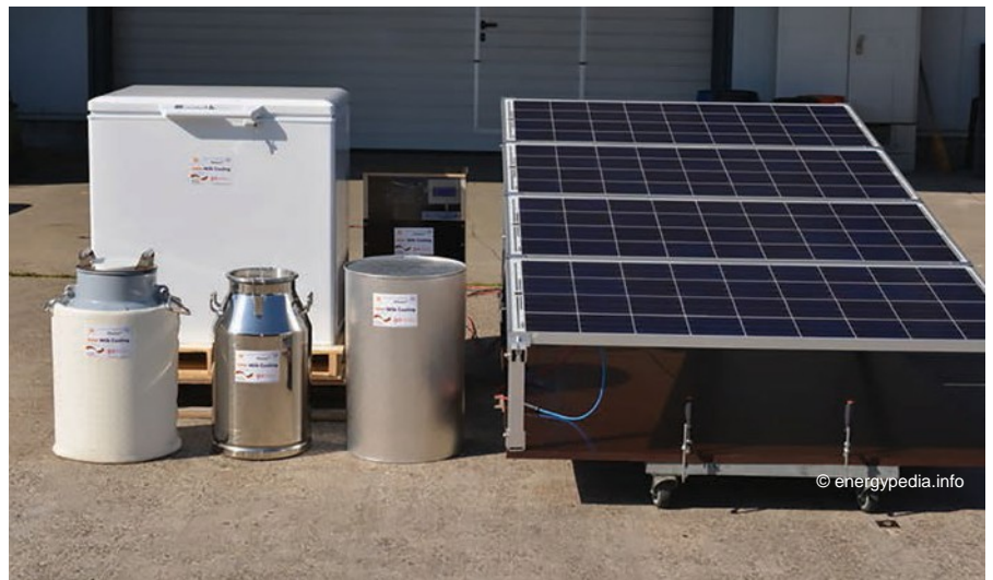
写真1：ミルク缶を冷却するための簡単なソリューションの例。生乳を急速に冷却するためのソーラーパネルの発電による冷凍庫。
