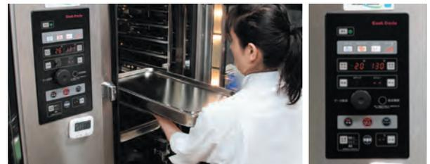
⑥蓋をして、スチコン(コンビモード130℃-20分、蒸気量100%)で加熱する。
