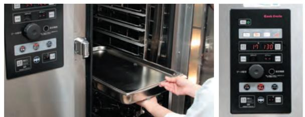
④蓋をして、スチコン(コンビモード130℃-20分、蒸気量100%)で加熱する。
