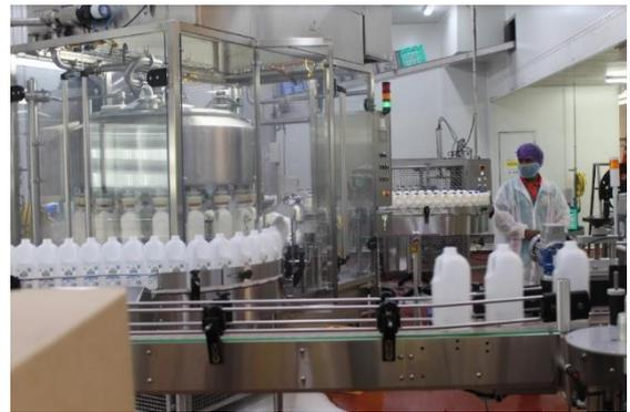
牛乳の充填ライン。1日に最大1万5000本の牛乳を生産する
